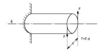
Fig. Shaft in Torsion
