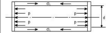
Fig. Longitudinal Stress
