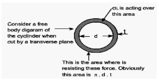
Fig. Longitudinal Stress
